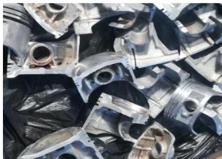
**Figura 4:** Pistones cortadas en secciones pequeñas
